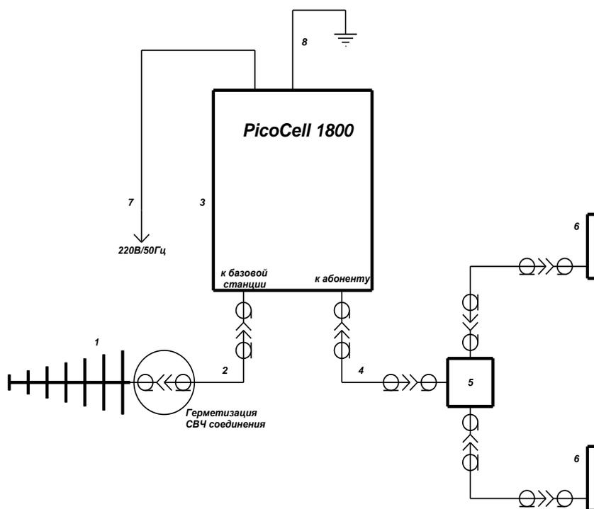
1. Наружная антенна, направленная к базовой станции.
