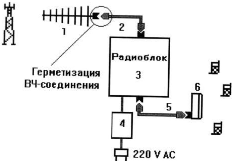
1. Наружная антенна, направленная к базовой станции.
