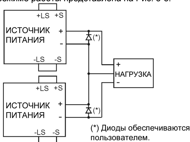
Рис.5-3: Последовательное соединение для получения положительного/отрицательного выходного напряжения
