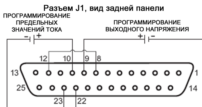
Рис.6-1: Подсоединение внешнего программирования уровнями напряжений
