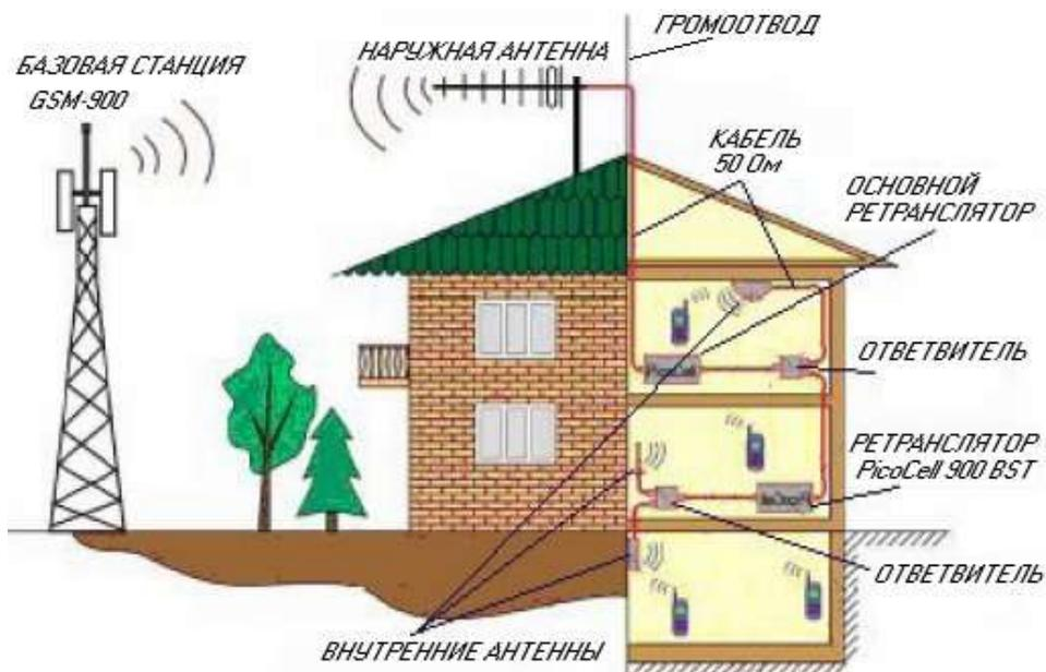
Типичная схема системы с ретранслятором **PicoCell 900 BST** изображена на рисунке.
