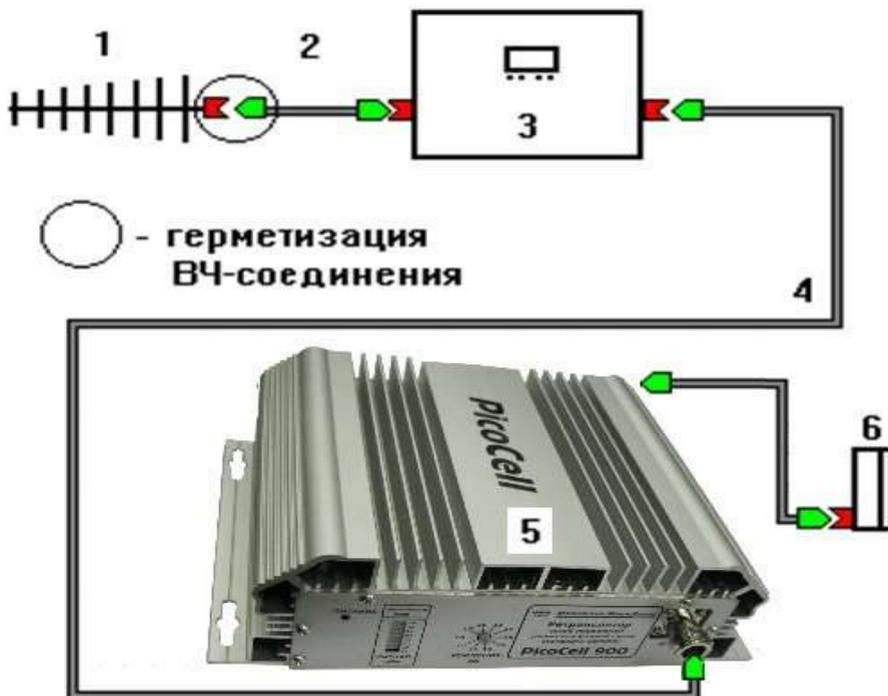
1. Наружная антенна, направленная к базовой станции.
