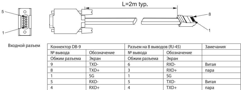
Рис. 7-4: Кабель RS485 с соединителем DB9 (P/N: Z/485-9)
