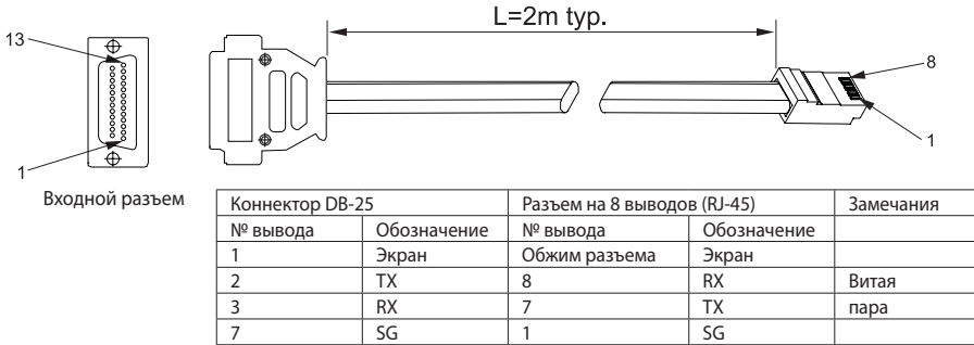
Рис. 7-2: Кабель RS232 с соединителем DB25 (P/N: Z/232-25)
