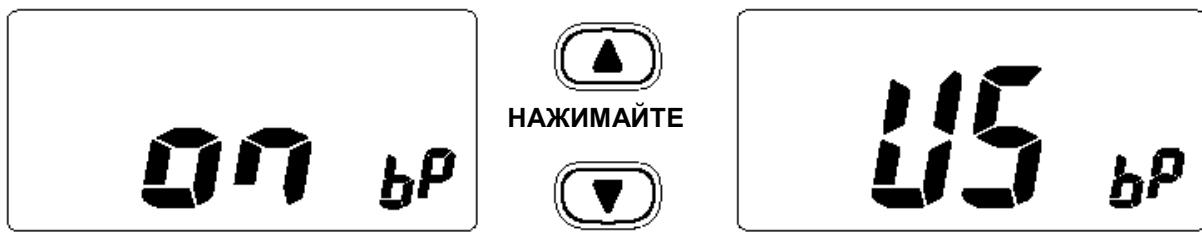
Звуковой сигнал включен
