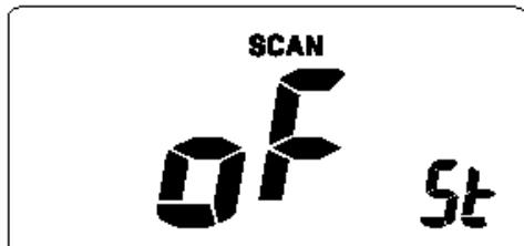
Таймер выключен ( заводская установка)
