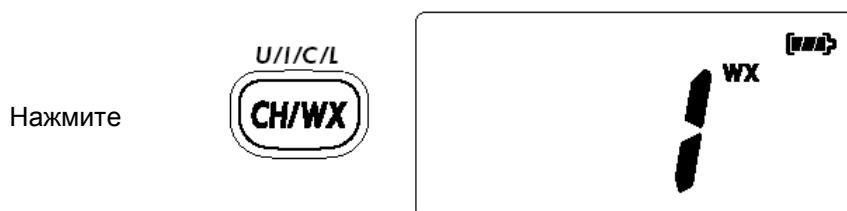
**ДЛЯ ВАШЕГО УДОБСТВА:** Радиостанция IC-M88 может принимать тональный сигнал погодного предупреждения на выбранном погодном канале в процессе приема других каналов, в режиме ожидания на рабочем канале или в процессе сканирования
